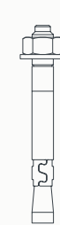
Fijación metálica expansiva 8x92 Expanding metal fixing 8x92 Fixation métallique expansible 8x92 Расширяющийся металлический крепеж 8x92
